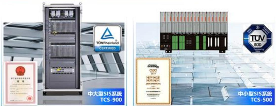
中控安全仪表系统 (TCS-900&TCS-500)，是中控技术面向流程工业的 ESD、F&GS、GDS、BMS、HIPPS 等应用场景自主研发的工业控制系统，针对不同工艺装置规模以及基础投资建设要求，提供安全性与经济性最佳平衡的产品组合解决方案，保障企业的关键设备及高价值工艺的安全运行，降低人员生命安全风险。中控安全仪表系统具备高安全性、高可靠性、高可用性的三高特性。1) 高安全性：功能安全等级 SIL3、安全架构  $2 \times 2oo3D$ 、故障诊断覆盖率>99%、信息安全 IEC 62443
