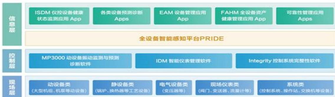
作为流程工业智能化解决方案提供商，中控技术在设备智能化管理领域深耕多年，已经为客户提供诸多设备智能化软件，如智能设备管理软件 IDM、智能仪控管理软件 ISDM、全设备资产健康管理软件 FAHM、设备管理软件 EAM、机组状态监测与诊断软件 MP3000 以及控制系统完整性软件等，这些软件的应用为客户创造了独特价值。在此之上，中控技术于 2023 年发布了全设备智能感知平台 PRIDE (Perception of Readable Instruments, Devices and Equipments)，这是中控技术创新研发的新一代设备智能感知平台，帮助企业用户解决现场各类设备的智能感知和预测诊断，实现工厂设备“诊断一张网”的故障排查和诊断分析能力，可有效大幅度降低设备非计划停车现象。设备健康监控系统对各类设备的状态监测及故障诊断，可以实现智能化、自动化生产，并带来避免非计划停车、降低维保成本、延长设备寿命等多项优势。
