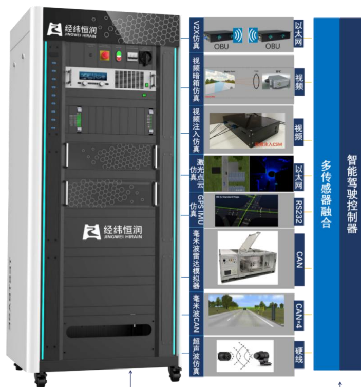
图：发行人应用于智驾测试的仿真测试系统
