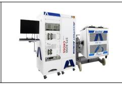
为客户提供基于 STS8200 测试平台的 PIM 专用测试解决方案、针对用于 大功率 IGBT/SiC 功率模块及 KGD 测试
