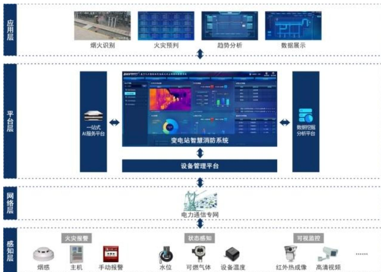
该系统感知层包含了火灾报警装置、状态感知装置、可视监控装置等智能感知单元；平台层包含了设备管理平台、一站式 AI 服务平台、数据挖掘分析平台等软件平台；应用层包含了烟火识别、火灾预判及趋势分析等功能应用。
