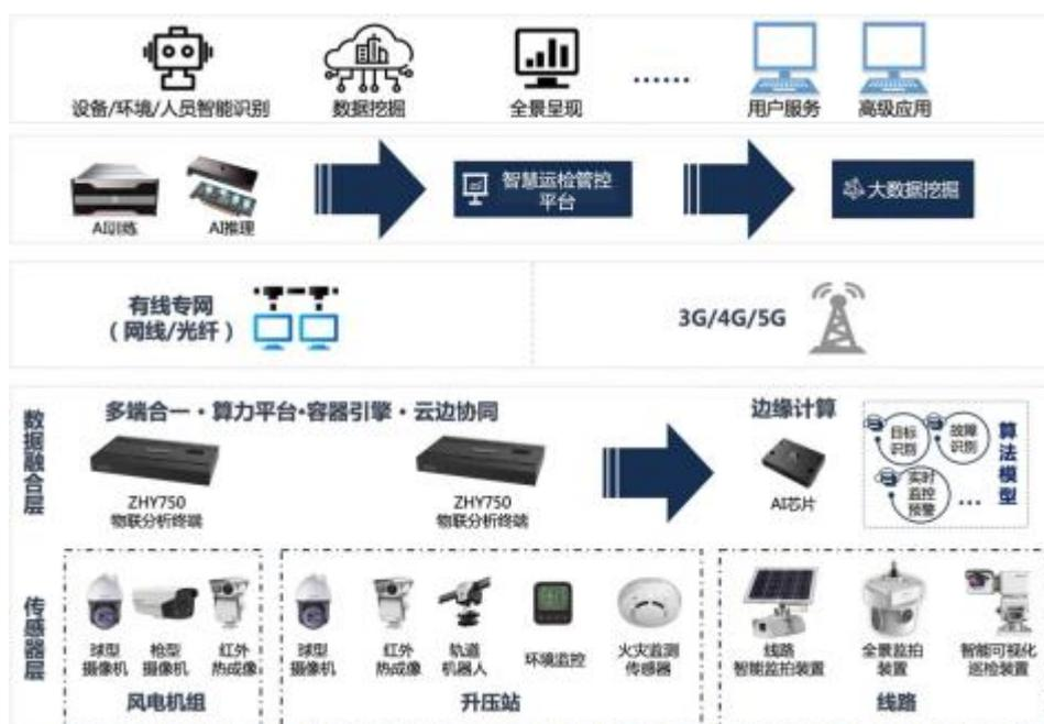
智洋创新结合风电场、升压站、集电线和送出线等不同场景巡视需求，从硬件形态定义、软件架构延展、施工部署等方面优化，推出基于物联网与边缘智能的风电场在线智能巡视方案，包含风电机组、升压站和集送线路的智能巡视，24 小时全天候可视化自动巡视，减轻人工巡视工作压力、提高巡视效率。
