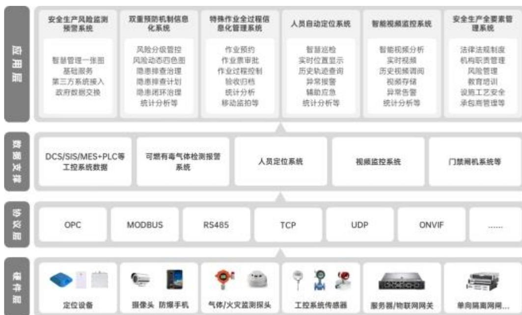
智慧化工危化安全生产管理系统的硬件层包含人员定位设备、厂区摄像头、物联传感器、服务器等危化品企业现有基础设施；硬件采集或生成的数据通过协议层中的多种协议传输至数据支撑层；数据支撑层包含各类工控系统、气体检测报警系统、人员定位系统、视频监控系统和门禁闸机系统等，各类数据在后台经过 AI 推理和统计分析后，会在应用层得以呈现；应用层包含安全生产风险监测预警系统、双重预防机制信息化系统、特殊作业全过程信息化管理系统、人员自动定位系统、智能视频监控系統、安全生产全要素管理系统 6 大功能模块。
