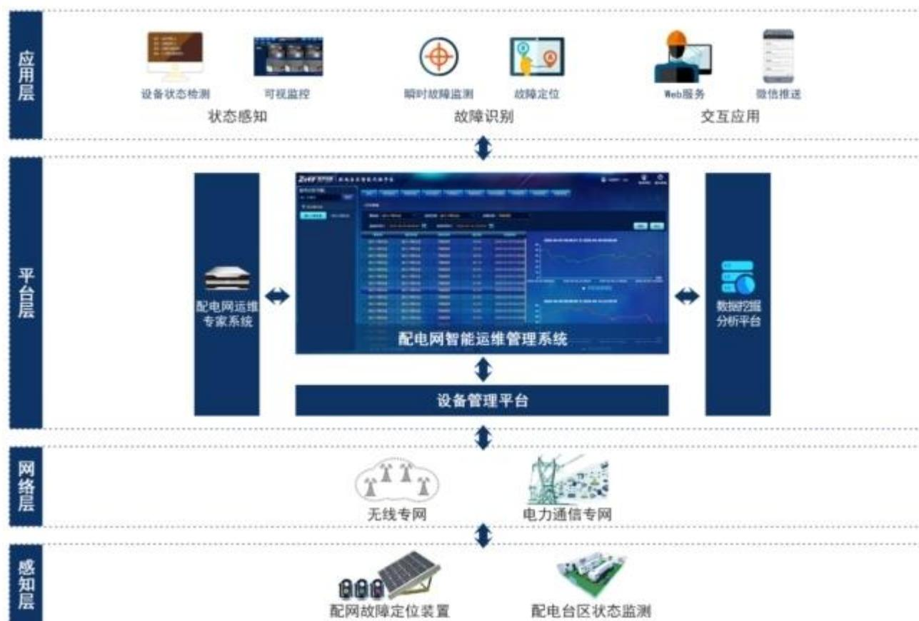
该系统感知层包含了配网故障定位装置、配电台区状态监测装置；网络层包含了无线网络通信单元；平台层包含了设备管理平台、数据挖掘分析平台、配电网运维专家系统等软件平台；应用层包含了状态感知、故障识别、交互应用等功能应用。
