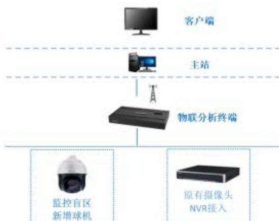
风电机组智能巡视系统部署在每台风机内，主要由物联分析终端、高清视频等组成，通过对风机进行智能化、物联网化升级改造，结合人工智能识别技术，实现风机远程监控、自动巡视、安全隐患识别、故障预警与告警功能。
