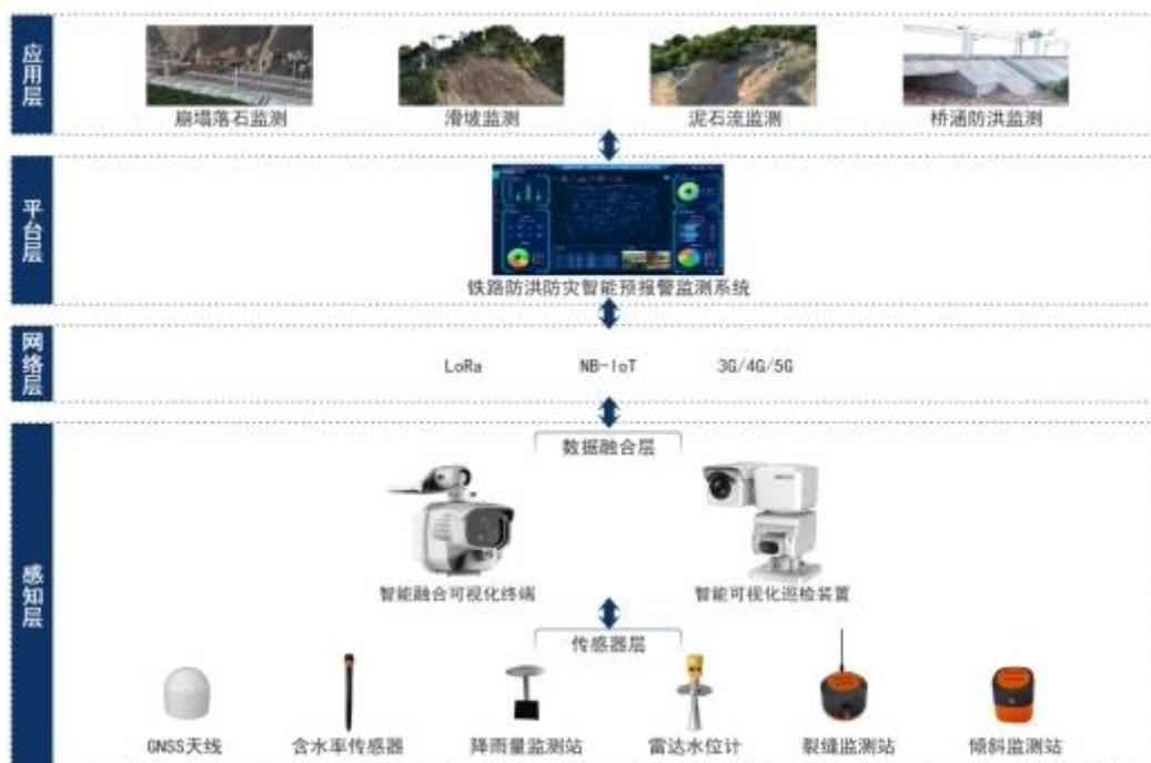
该系统分为现场自动监测报警和分析发布两大部分，其中自动监测报警部分由前段传感器设备、数据通讯设备、平台数据处理软件、监控报警模块组成，分析发布部分由数据分析发布与信息共享系统组成。
