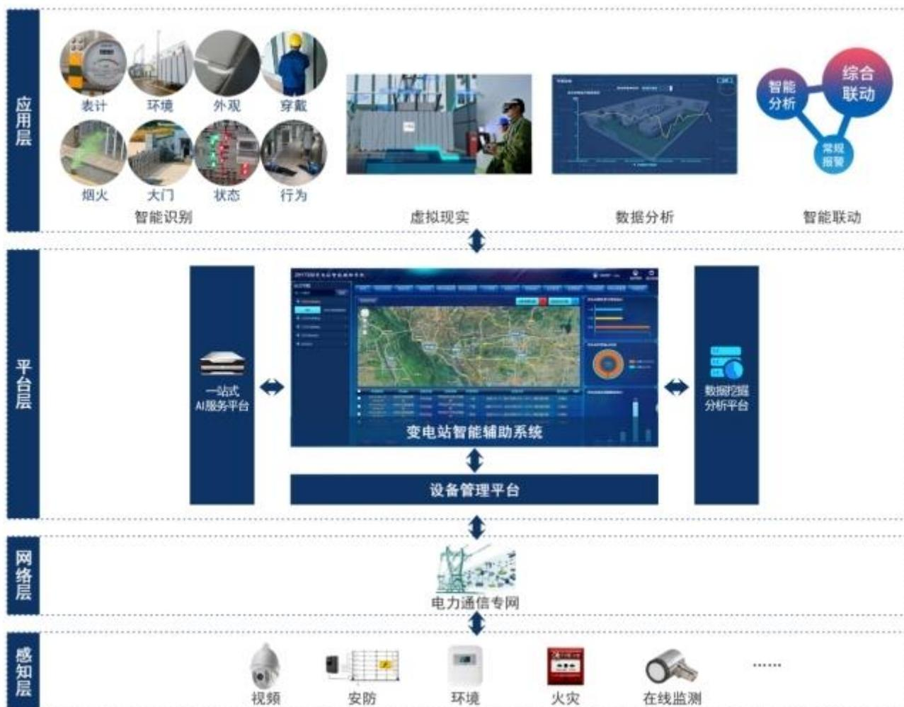
该系统感知层包含了视频监控装置、环境监控装置、安防监控装置等智能监控单元；平台层包含了设备管理平台、一站式 AI 服务平台、数据挖掘分析平台等软件平台；应用层包含了远程监控、智能识别、虚拟现实、数据分析及智能联动等功能应用。公司变电站智能辅助系统包括无线测温系统、微环境治理系统、高压室综合治理系统、六氟化硫泄漏报警监控等子系统或模块，各子系统和模块可以单独对外销售。
