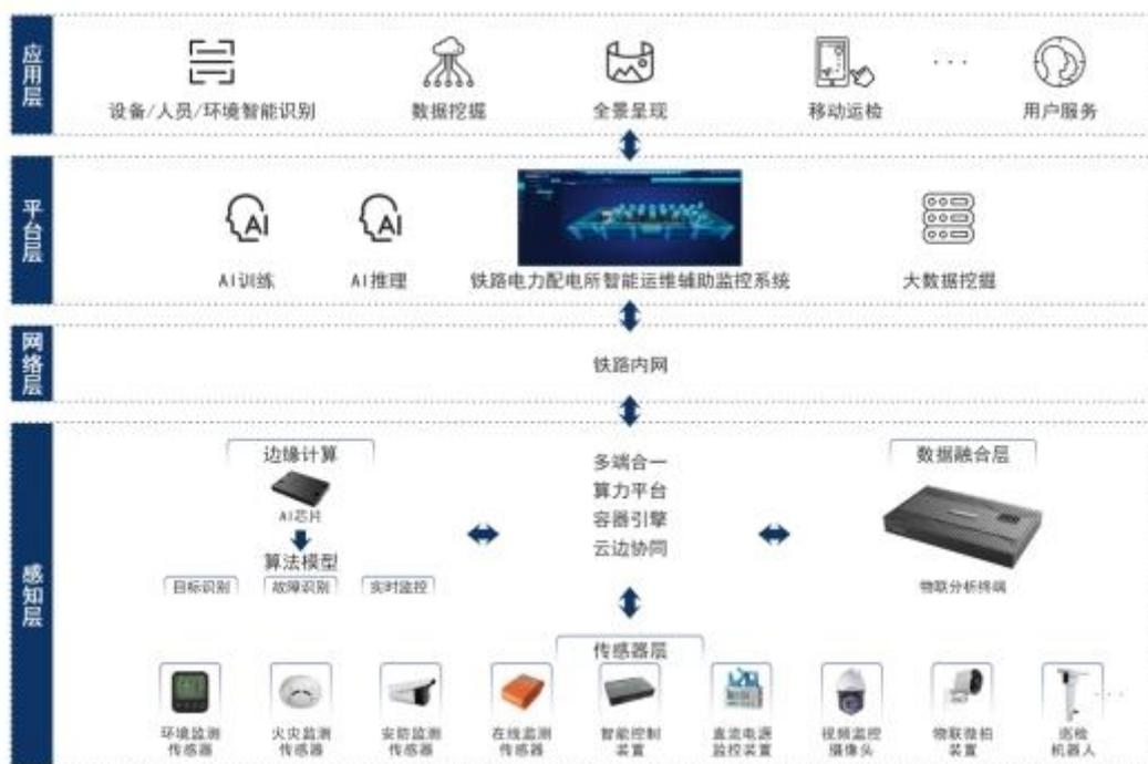
该系统感知层包含了视频监控装置、环境监控装置、安防监控装置等智能监控单元；平台层包含了设备管理平台、一站式 AI 服务平台、数据挖掘分析平台等软件平台；应用层包含了远程监控、智能识别、虚拟现实、数据分析及智能联动等功能应用。
