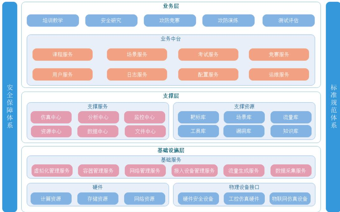
①基础设施层：作为整体靶场平台的底座，主要包含了靶场需要的基础硬件资源及基础服务两大部分。其中，基础硬件主要包括资源硬件及物理仿真设备接入；基础服务是底层硬件与靶场上层应用的连接通道，通过基础服务的封装将基础硬件能力开放给靶场上层应用使用，具体包括虚拟化管理服务、容器管理服务、网络管理服务、接入设备管理服务、模拟仿真服务和数据采集服务。
