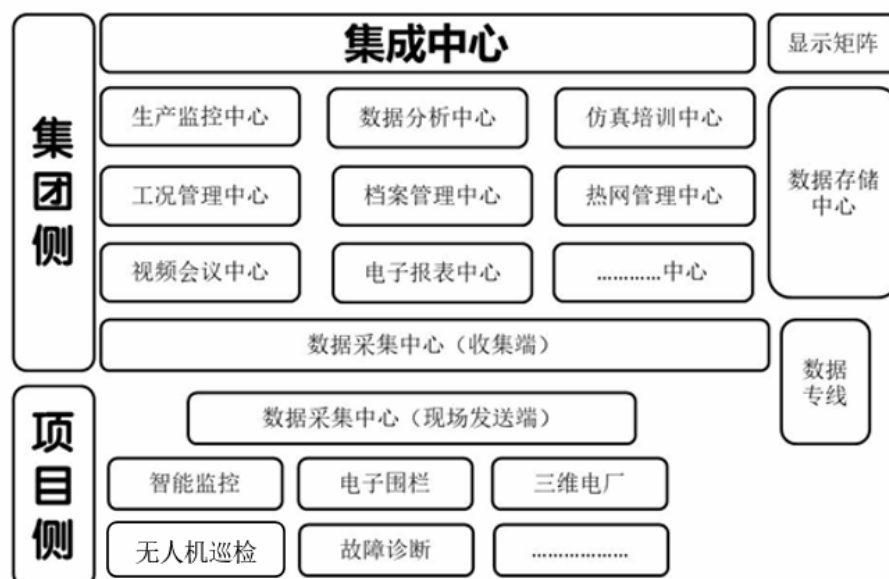
杭州热电集团信息中心结构分层图
