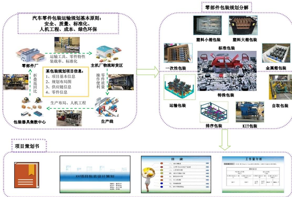
(2) 在包装器具设计环节，联明包装按照包装方案策划书形成的具体方案，根据零部件的规格、材质、外形等信息，以安全、质量、成本、人机工程、标准化、绿色环保为基本原则，对零件所需的包装器具进行概念设计、论证、图纸设计、打样、测试等工作，最终形成定型的包装器具设计施工图等技术文件，并统一交付给客户。
