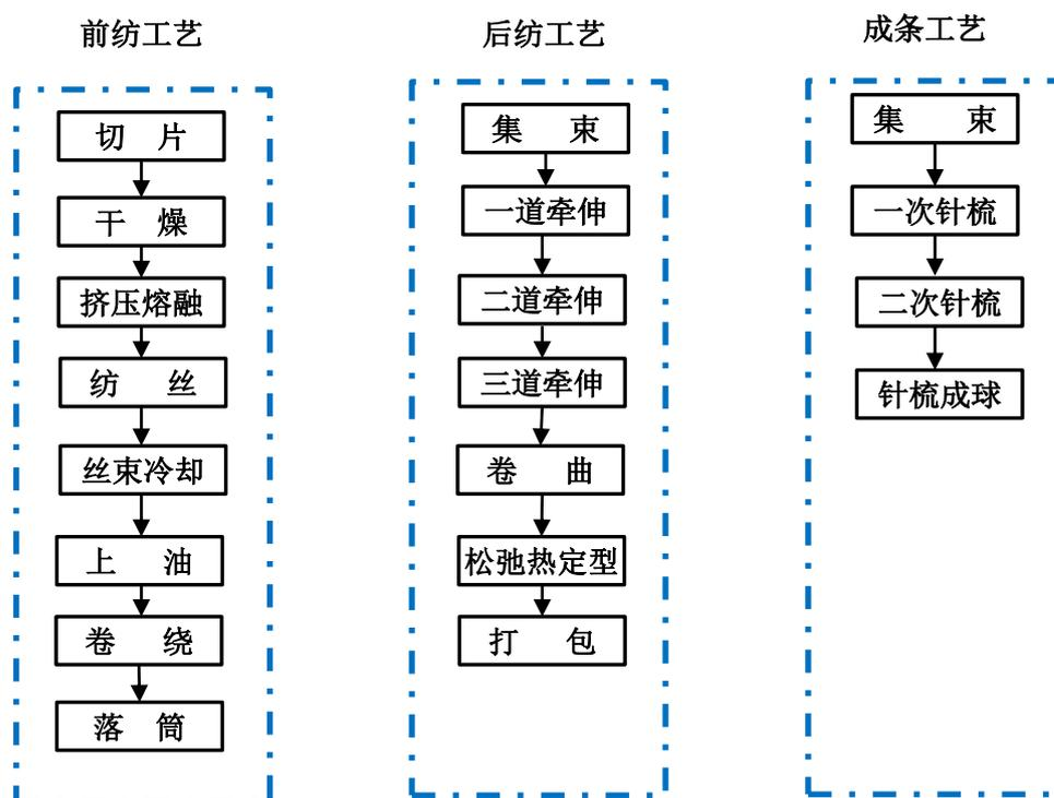
复合短纤维生产工艺与流程
