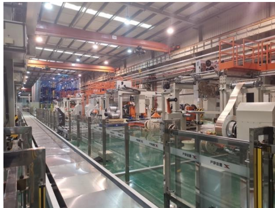
图：上海基地现代工厂非晶立体卷变压器产线
