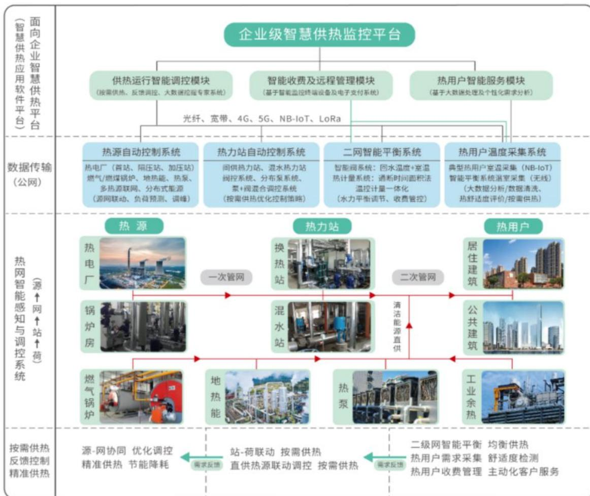
智慧供热平台构建了省、市、县、企业的供热信息化系统，形成“三级监管、四级联动、企业调控”的运行管理机制以保障城市供热安全、提高民生服务水平；通过基于室温监测的“荷、站、网、源”反馈调控策略，达到站荷联动、源网协同，从而实现按需供热、精准供热，提高了城市供热资源的配置效率，智慧供热已在北方采暖区成为智慧城市建设的垂直应用领域之一。
