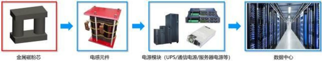
公司金属磁粉芯产品在数据中心领域主要应用于不间断电源（UPS）、通讯电源和服务器电源中。
