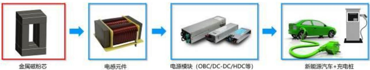
公司的金属磁粉芯产品在新能源汽车领域主要应用在车载OBC、DC/DC及HDC等电源模块中，以及作为新能源汽车配套设备的充电桩中。
