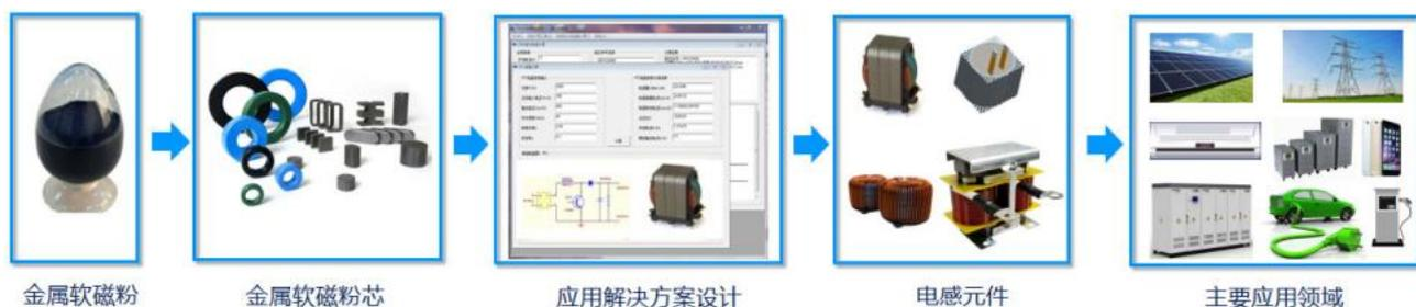
报告期内，公司主要从事金属软磁粉和金属软磁粉芯的研发、生产和销售，为电能变换各环节的电力电子设备或系统实现高效稳定、节能环保运行提供高性能软磁材料以及电感元件整体解决方案。凭借着行业领先的技术创新和产品研发能力，不断推出匹配市场需求的新材料产品，引领全球金属软磁粉芯行业的发展。
