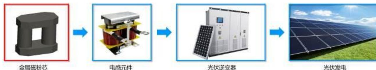
公司金属磁粉芯产品在光伏发电领域主要应用在光伏逆变器中。
