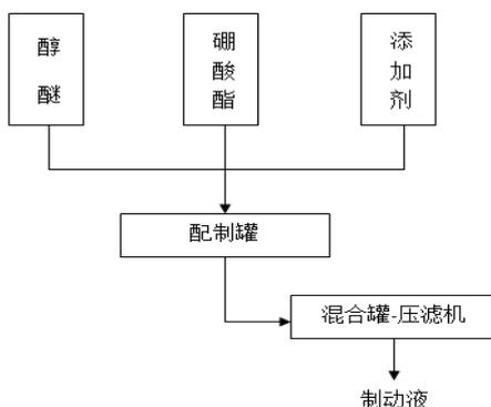
将原料醇醚、硼酸酯与添加剂按工艺要求在配制罐中搅拌混合均匀后，经压滤机去除固体杂质，即得制动液产品。
