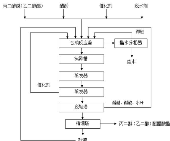
原料醚、醋酸、脱水剂、催化剂按工艺要求经计量加入反应釜中反应，反应产生的水经脱水塔的脱水剂从塔顶采出废水，经酯水分相器，上层脱水剂回反应系统，下层废水经废水处理系统处理达标后排放。反应液合格后经沉降槽沉降，上层清液进入脱轻塔减压精馏分离出中间组分回用，釜液进入精馏塔精馏出合格产品。残液富含催化剂回反应釜循环使用。
