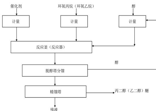
原料EO或PO、醇、催化剂按工艺要求经计量, 经过充分混合后, 经预热进入反应釜(器)进行醚化反应, 反应结束后反应液进入脱醇塔回收原料醇, 釜液进入多段精馏塔精馏出丙二醇(乙二醇)醚。
