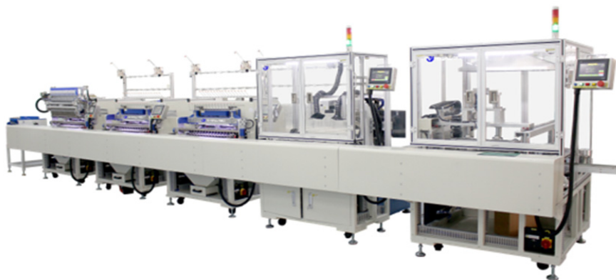
全自动变压器流水线
