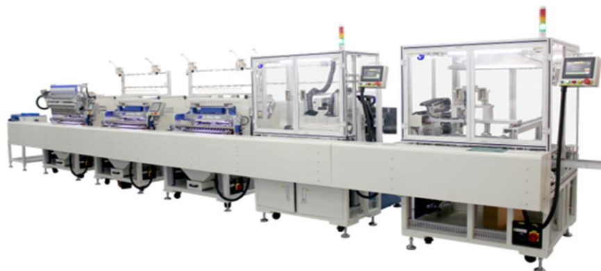
全自动变压器流水线
