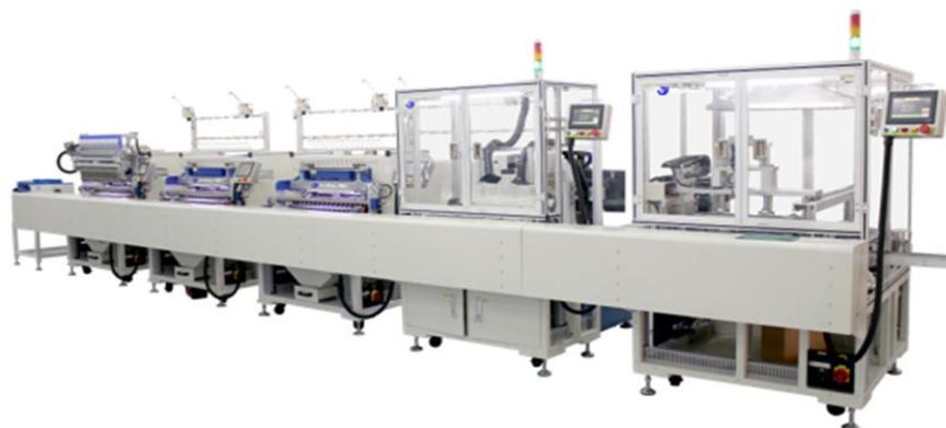
全自动变压器流水线
