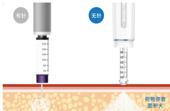
图 13 无针注射器和有针注射器注射过程对比
