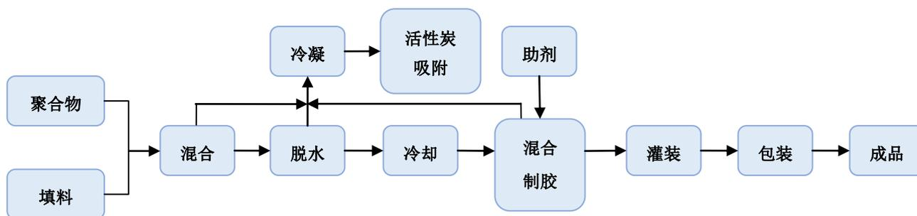
(2) 双组分有机硅密封胶生产工艺流程
