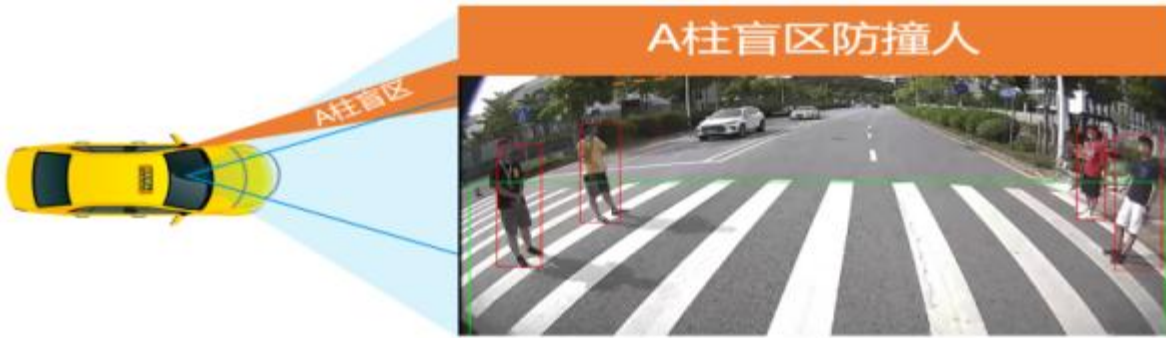
图9 出租车A柱盲区防撞人系统
