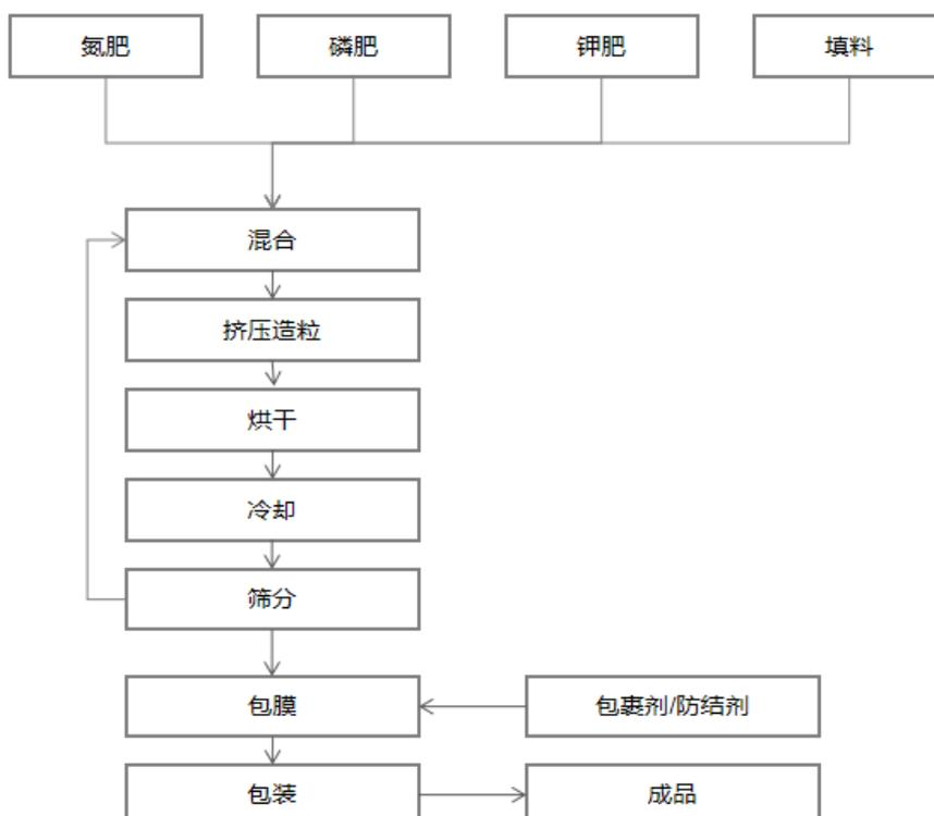
(4) 转鼓复合肥生产工艺流程说明：转鼓工艺制备复合肥的主要原料尿素、硝磷复肥、磷肥、钾肥，经计量的尿素或硝
