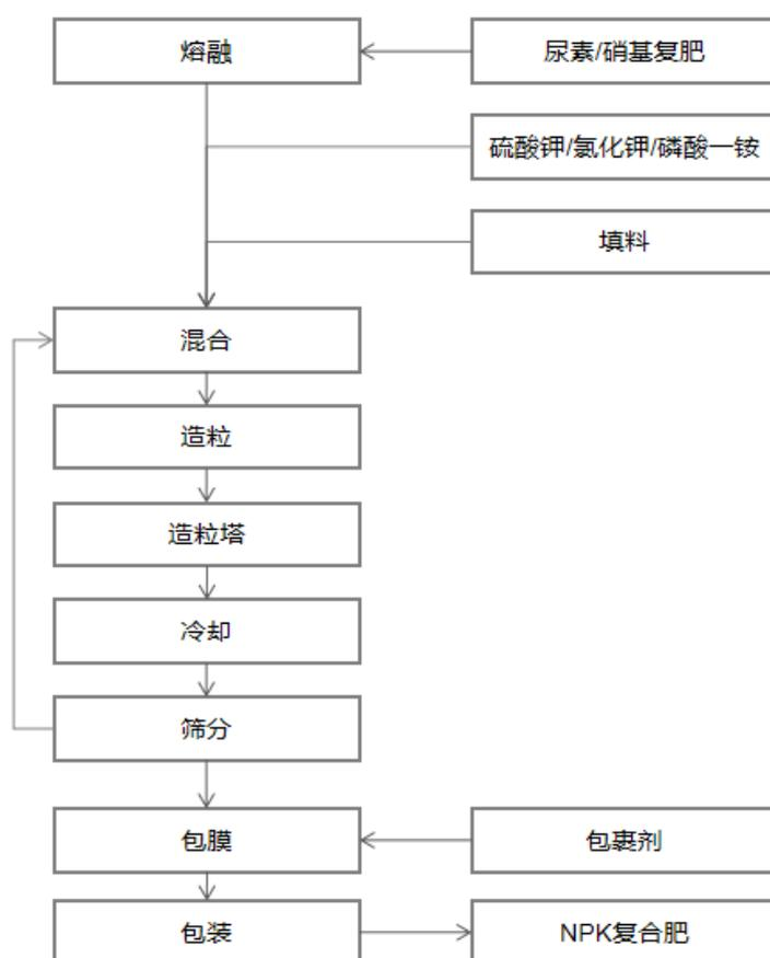
（2）冠肥生产工艺流程说明：制备复合肥的几种主要原料硝磷复肥、尿素、磷肥、钾肥中，硝磷复肥和尿素的熔点低，首先把称量过的硝磷复肥（或尿素）提升到熔融槽中熔融。粉碎并称量后的磷肥和钾肥提升到一级混合槽与来自熔融槽里的硝磷复肥（或尿素）熔体混合。后进入二级混合槽里进一步混合均匀。然后熔体泵入造粒机喷洒成液滴，液滴在冷却机上进行传热、传质，固化成颗粒后进入皮带输送机。温度约为45℃的颗粒物料经冷却、筛分、包裹等工序，合格粒子送往仓库包装。大小不合格颗粒经破碎后送到混合槽再混合。
