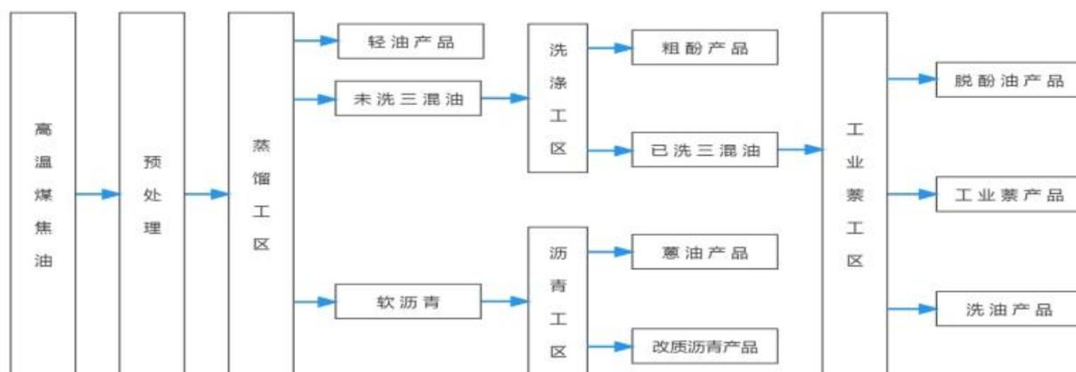
高温煤焦油是焦化工业的重要产品之一，其组分为复杂。该工艺利用焦油中各组分沸点不同的性质，通过塔式常、减压蒸馏工艺分离出不同产品。
