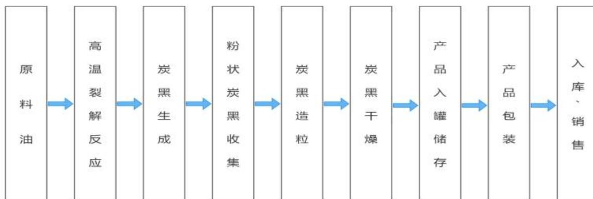
炭黑反应生成过程炭黑生产的核心是炭黑反应炉，燃料与空气先在反应炉的燃烧室完全燃烧产生高温烟气，并高速流经喉管。在喉管处，原料油由喷枪喷入反应炉，高温裂解反应生成炭黑及尾气。在此过程中，通过控制风、油配比、
