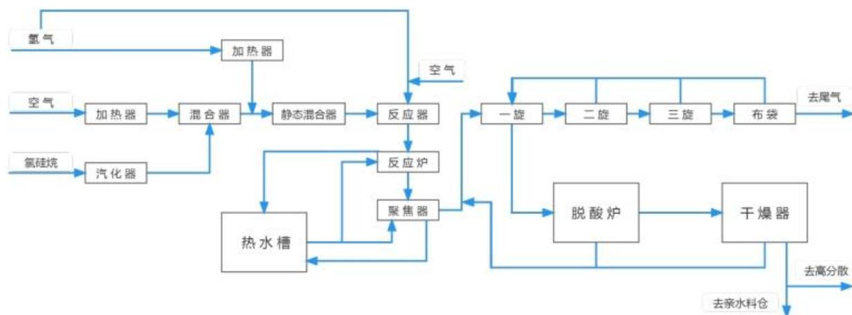
气相法白炭黑主要是通过化学气相沉积法，又称热解法、干法或燃烧法制得。其原料一般为四氯化硅、空气和氢气，
