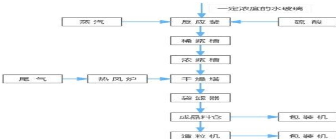
沉淀法白炭黑利用硅酸钠与硫酸反应制得，液体水玻璃加水调节到 20%-30% 的浓度送入下一道工序进行合成，在合成釜内先加入一定量的水和水玻璃，在 80-90℃ 温度下，同时加入硫酸和水玻璃并搅拌而生成白炭黑浆料，将浆料进入压滤机进行压滤，并用清水洗去其中的硫酸钠再进入打浆槽制得浓浆，用炭黑尾气燃烧产生的烟气与空气热交换，得到 500℃ 左右热风将经过雾化机雾化浓浆干燥为白炭黑粉末，用袋滤器收集后进行包装，根据需求，可将粉末状的白炭黑进行造粒，变成块状白炭黑进行包装销售。
