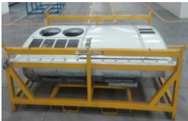
图 3-12 CRH1 平台动车组空调检修产品
