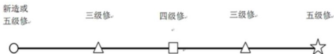
图 3-10 动车组高级检修周期循环图
