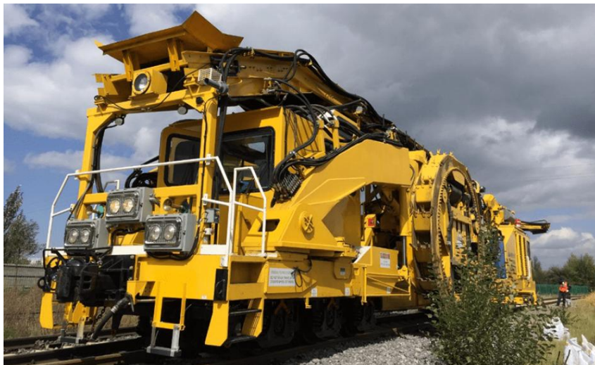
图 3-14 哈斯科 G04S-III-CN 型道岔清筛车
