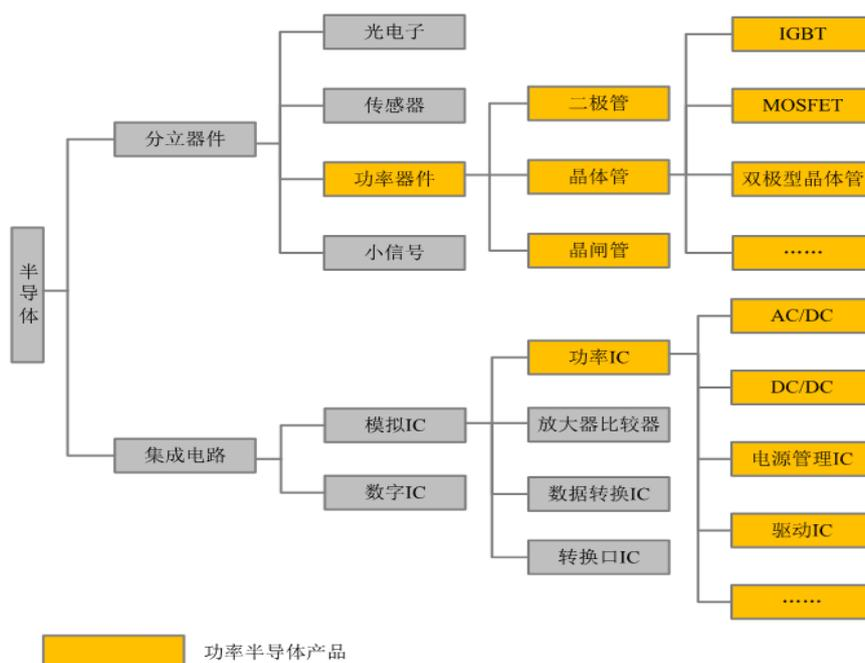
功率半导体是电子装置中电能转换与电路控制的核心，主要用于改变电压和频率、直流交流转换等。功率半导体可以分为功率 IC 和功率器件两大类，其中功率器件主要包括二极管、晶闸管、晶体管等产品。二极管和晶闸管出现的时间相对较早，总体结构和生产工艺较为简单。IGBT 属于晶体管系列，拥有输入阻抗高、开关速度快、易于驱动等技术优势，已逐步取代晶闸管，处于下游高景气阶段。
